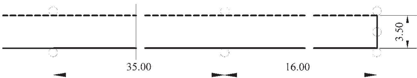
Слика 27. Простор и ознаке простора за извођење полигонске радње „вожња напред са променом степена преноса и уназад у истој саобраћајној траци” (за оспособљавање кандидата за возаче возила категорије M)
